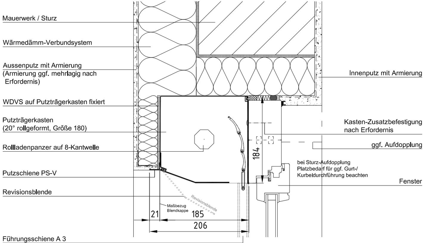
Der Putzträger-Kasten darf sich nicht bewegen und ist zusätzlich zu befestigen.
